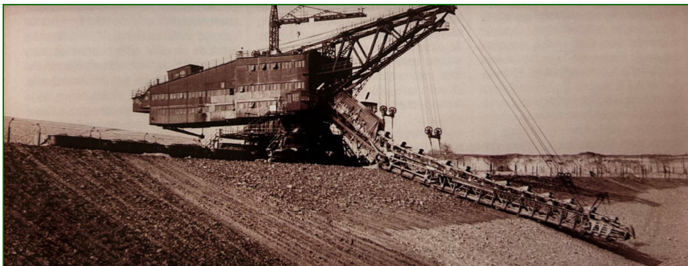
Obr. 4: Korečkové rýpadlo DO 800 na dole Jirásek—Emeran
