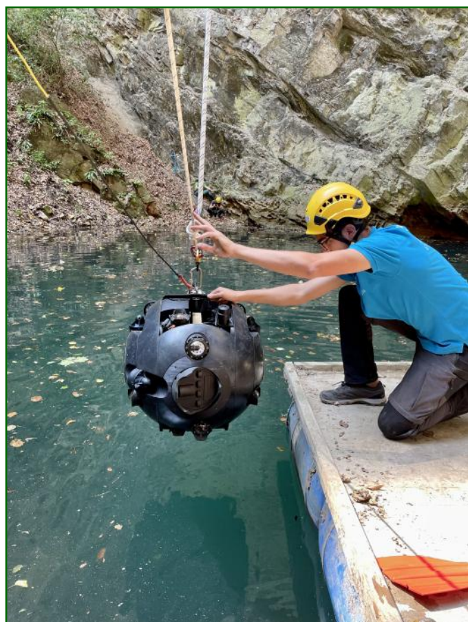
Obr. 5: Spouštění robota na hladinu Jezírka ke kalibraci — foto Pavel Fryšák
