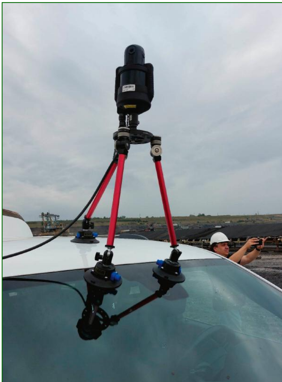
Obr. 11: Skener HERON LITE Color od firmy Gexcel.
