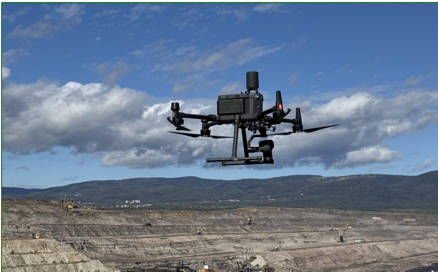
Obr. 1: Dron DJI M300 RTK s kamerou DJI Zenmuse P1 (foto AEROVISION Group s.r.o.)
