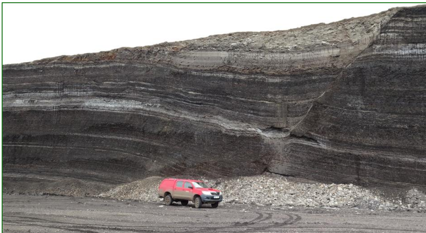
Obr. 3: Těžební řez na dolech Nástup Tušimice. Na tomto příkladu by geolog zakreslil výrazné světlé jílovité proplástky v uhelné sloji a zejména tektonickou poruchu (zlom) v pravé části snímku. V takto dokonalém stavu řezu by byla použitelná i metoda UAV.
