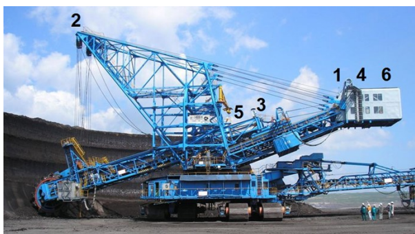
Obr. 1 Rozmístění GPS a inerciálních snímačů na rýpadle K800/103.
