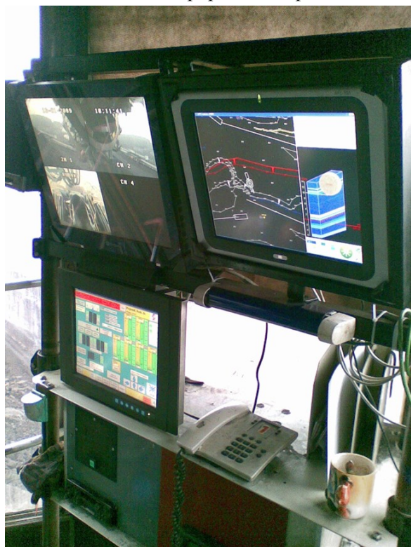
Obr. 4 Kabina rýpadla KU300/27 – vpravo obrazovka s aplikací „GPS – kabina“
