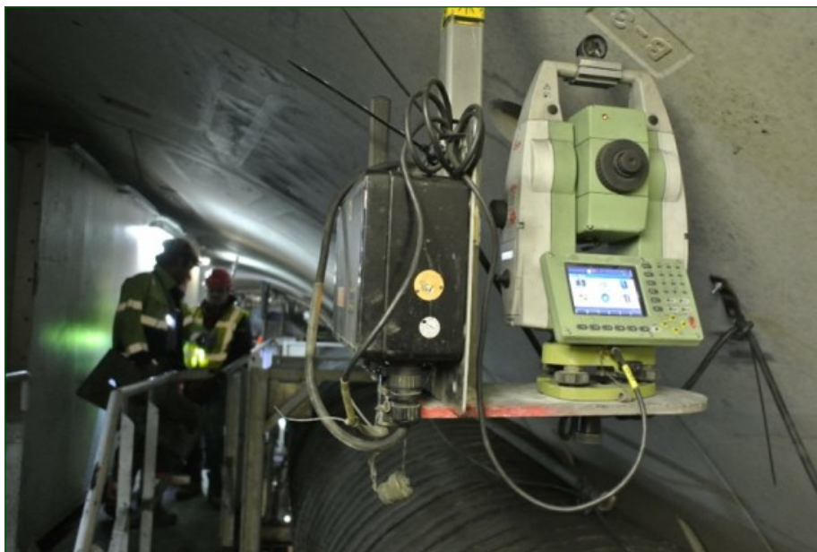
Obr. 11 Tunely Ejpvovice, S799-Viktorie, navigační TC na konzoli
